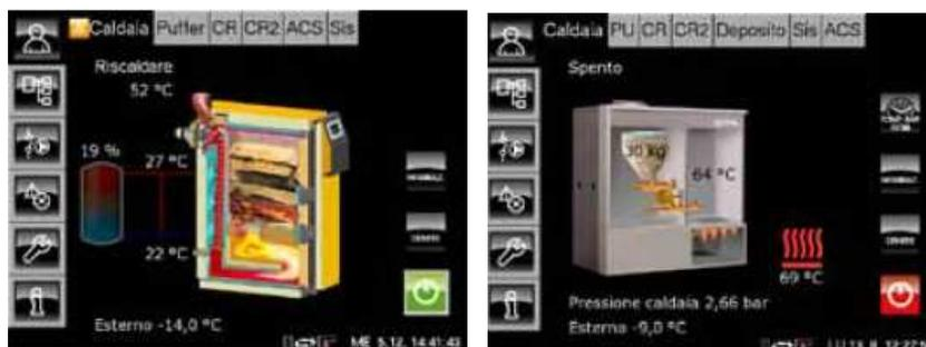
ETA TWIN utilizza un display touchscreen a colori 5,7" integrato nella caldaia, denominato ETAtouch, ad uso intuitivo, per gestire le principali funzioni di un impianto di riscaldamento e la combustione controllata tramite la sonda LAMBDA, la sonda di temperatura dei gas di scarico e il ventilatore d'aspirazione gas a giri variabili.
